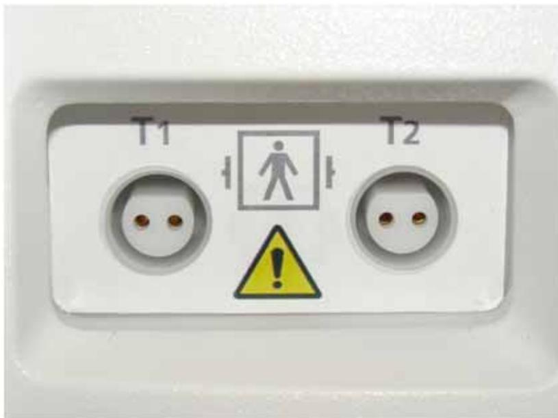
Рис. 2.4. Разъемы датчиков температуры
