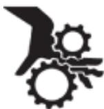
**ПРЕДУПРЕЖДЕНИЕ. Возможно травмирование пальцев.** Соблюдайте осторожность при установке трубок роликового насоса, чтобы пальцы не зажало роликом. Во время работы консоли не пытайтесь вскрыть защитную блокировку крышки роликового насоса. Не кладите пальцы или посторонние предметы на желоб насоса при вращении роликов. Роликовый насос имеет достаточный крутящий момент, чтобы серьезно повредить пальцы.
